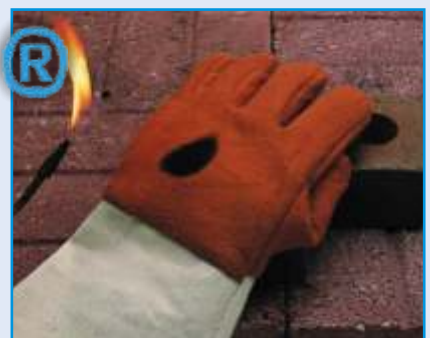
COMFOflex postava ne gori niti nakon 4 sec. izloženosti otvorenom plamenu.
